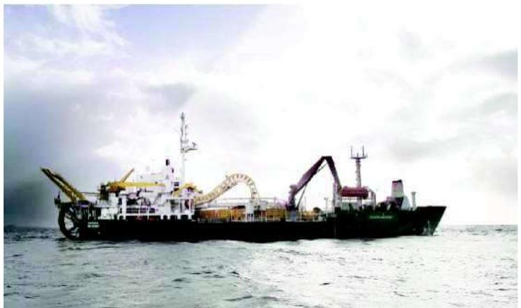
Figure 13 - Bateau pour le déroulement des câbles
