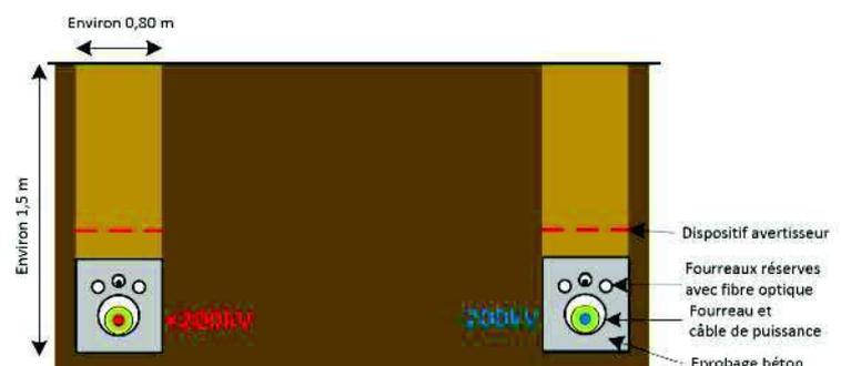
Figure 11 - Croquis de principe d'une ligne souterrain, source EDF
