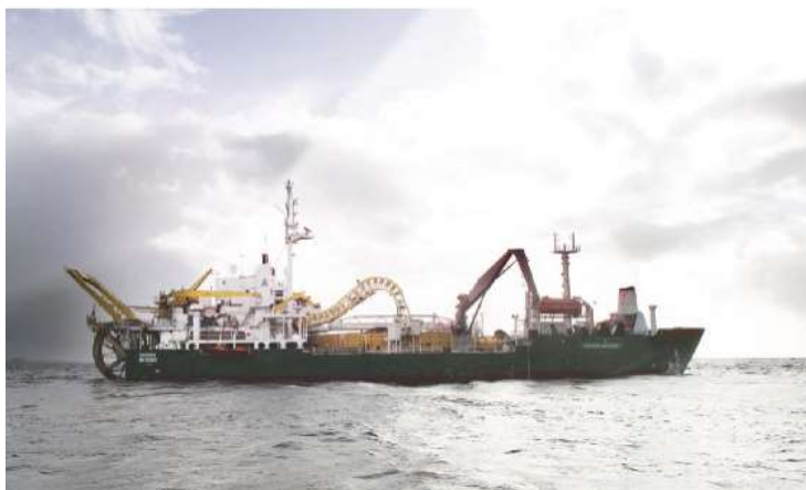
Figure 9 - Bateau pour le déroulement des câbles
