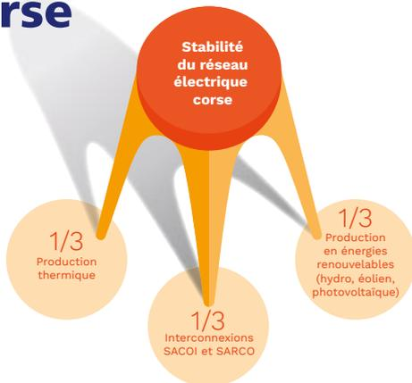
Depuis 1986, la station de Lucciana apporte à la Corse 50 MW d'électricité, et doublera sa capacité grâce au projet SACOI3. Avec SARCO (autre liaison venant de Sardaigne), elle compte pour 1/3 dans l'alimentation électrique de la Corse.
