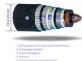
Ainsi, un câble sous-marin est de conception similaire à celle d'un câble souterrain, mais dispose en plus d'une armure externe permettant d'assurer sa pérennité en milieu marin.
